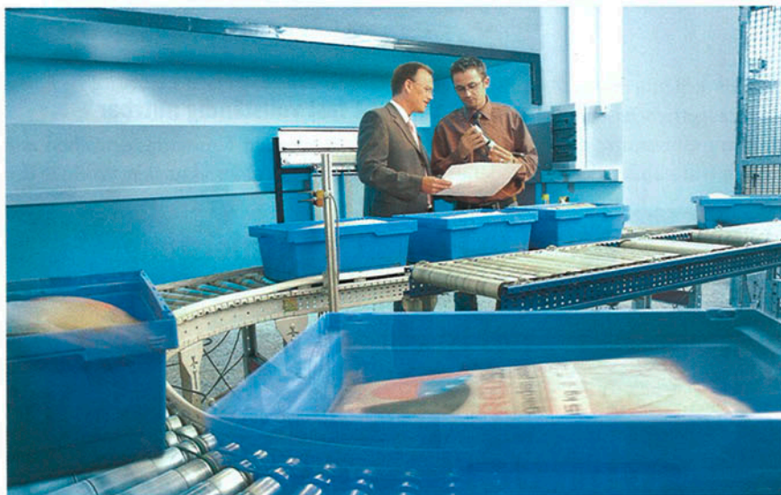
Anlagen mit relativ vielen Antrieben wie dieses Intralogistik-System haben das größte Sparpotenzial. Bei einer Studie gaben rund 800 Unternehmen der Förder- und Lagertechnik an, gut 65 Prozent ihrer Energiekosten für die Antriebstechnik aufzuwenden
